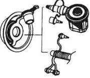
Pumpenschlauch oder Düse einsetzen.
