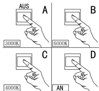
Die Leuchte wird über den Lichtschalter ein- / ausgeschaltet; durch kurze Schaltfolgen am Lichtschalter kann zusätzlich die Farbtemperatur geändert werden.
