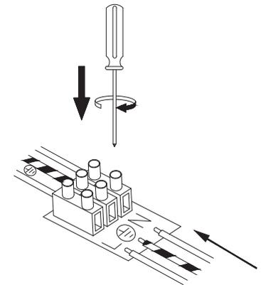
Den Elektroanschluss spannungsfrei durchführen! (s. Sicherheitshinweise)
