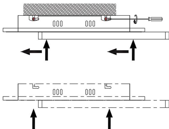
Leuchte an der Halterung einhängen und verschrauben
