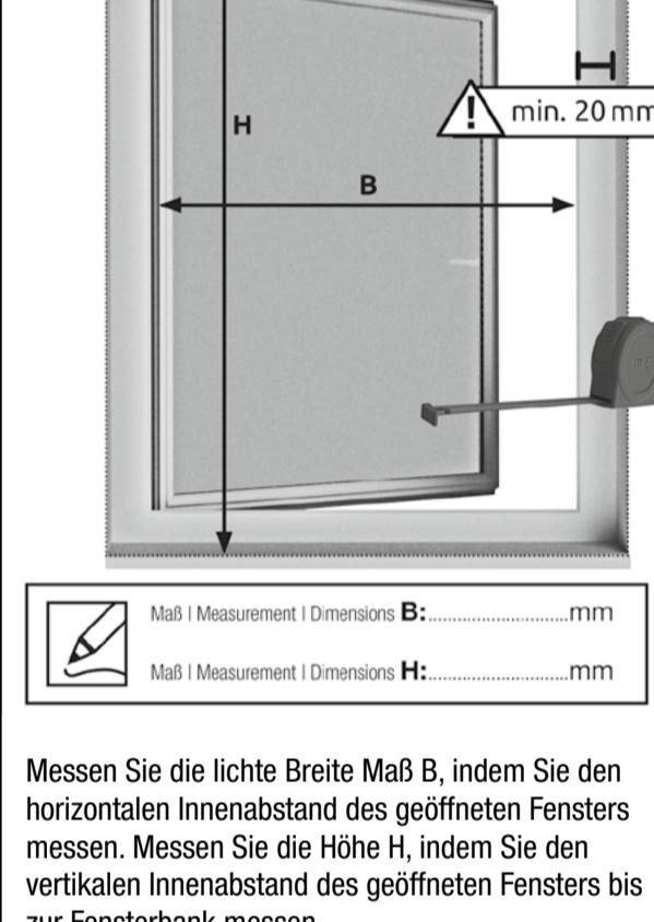
Messen Sie die lichte Breite Maß B, indem Sie den horizontalen Innenabstand des geöffneten Fensters messen. Messen Sie die Höhe H, indem Sie den vertikalen Innenabstand des geöffneten Fensters bis zur Fensterbank messen.
