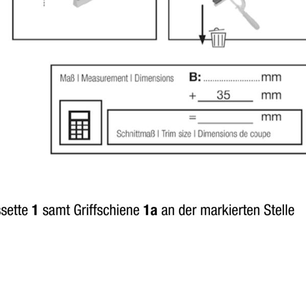
Markieren Sie an der Rollokassette 1 das Maß B zuzüglich 35 mm an der zu kürzenden Seite. Kürzen Sie die Rollokassette 1 samt Griffbahne 1a an der markierten Stelle mit einer Metallsäge und entgraten Sie die Schnittkanten mit einer Feile. Beachten Sie die Lage der Kassette.
