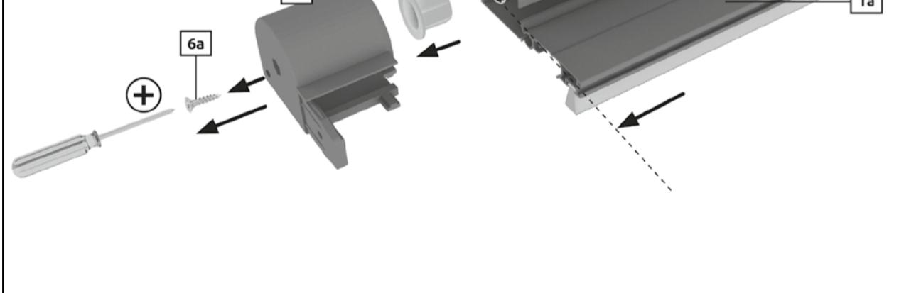
Entfernen Sie die Schraube 6a und ziehen Sie die Endkappe 6 und das Wellenlager 5a von der Kassette 1. Schieben Sie die Griffbahnen 1a bündig mit der Kassette 1.
