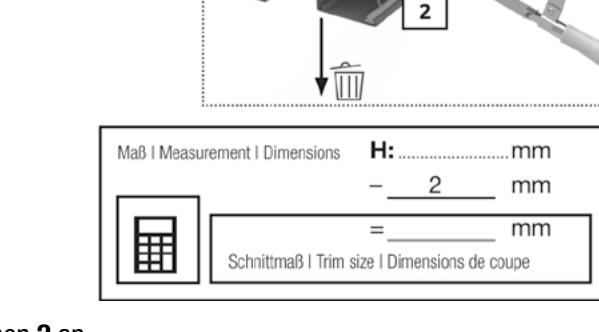
Markieren Sie an den beiden Führungsschienen 2 das Maß H abzüglich 2 mm. Kürzen Sie die beiden Führungsschienen 2 an der markierten Stelle mit einer Metallsäge und entgraten Sie die Schnittkanten mit einer Feile. Schieben Sie die Dichtungsbürsten an der zu kürzenden Seite bündig mit den Führungsschienen, um den Versatz zu erhalten.
