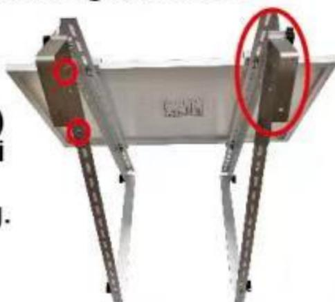
**2.8** Hängen Sie die gesamte Halterung an das Balkongeländer in die gewünschte Position, verriegeln Sie den Haken an der Aufhängungsstange mit den langen Schrauben (6) und befestigen Sie den Wechselrichter z.B. in der Mitte zwischen den Löchern des Hakens an der langen Schraube (6) oder direkt am Ende der langen Schraube (6) – siehe Abbildung 9. Achten Sie bei der Installation des Wechselrichters immer auf eine sichere Befestigung.
