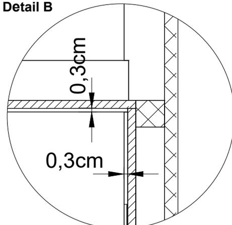
Lassen Sie im Türbereich rechts 3mm Luft an der Innenkante bis Sie das Dichtband A109 kleben. Auf der linken Seite fangen Sie bündig an.
