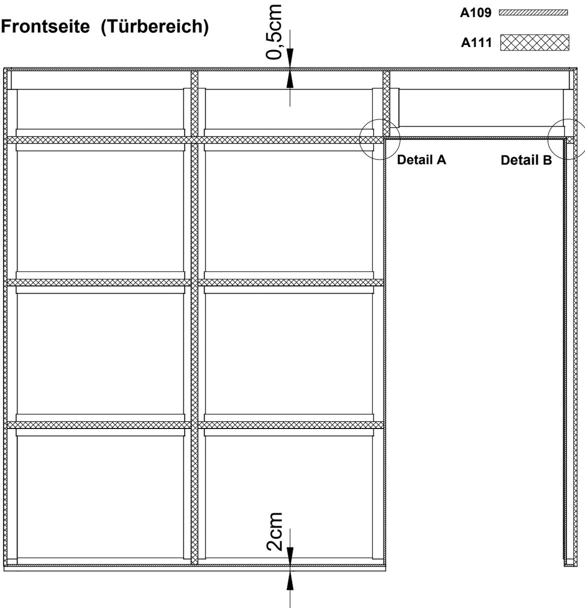
Beginnen Sie mit dem unteren Dichtband (A109) 2cm von der Unterkante des Gebäudes, von der Oberkante halten Sie 0,5cm Abstand.
