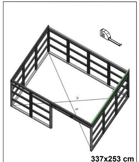
Mit Hilfe eines Maßbandes kontrollieren Sie auch die Diagonalen. Messen Sie die Diagonale in den Ecken der Schwellen nach, das Maß muss bei beiden Messungen das Gleiche ergeben.
