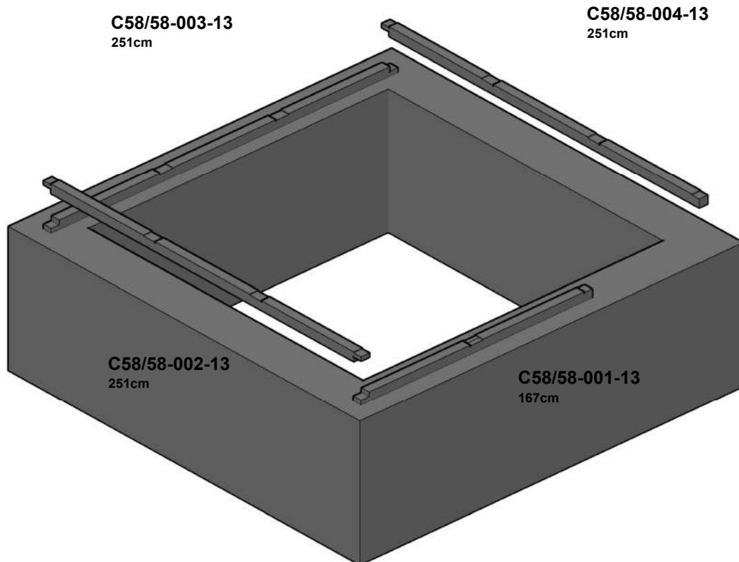
Legen Sie die Schwellen entsprechend auf dem Fundament bereit aber befestigen Sie diese noch nicht, um die Möglichkeit zu behalten das Gerüst bis zum Anbringen der Fassadenplatten noch auszurichten.
