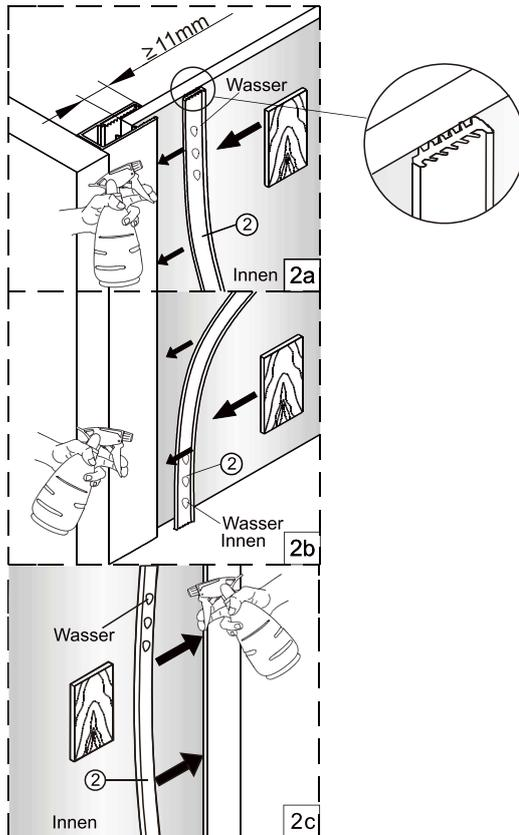
Die Glasdichtung muss im oberen und unteren Bereich, auf einer Länge von mindestens 10 cm eingesetzt sein. Ansonsten kann das Profil die Glasscheibe nicht halten.
