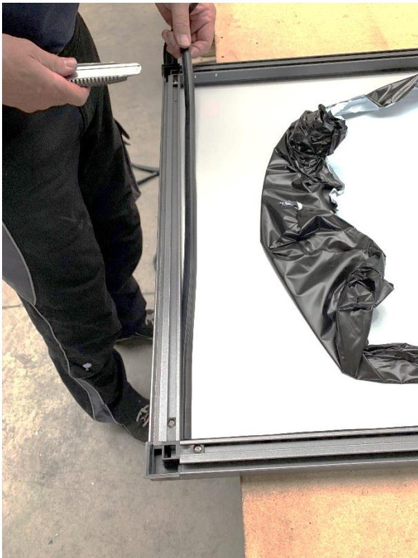
3. Die Dichtung auf die benötigte Länge kürzen
