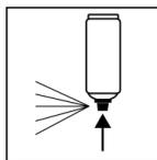
Nach Beenden des Lackiervorganges Dose umdrehen und Ventil leersprühen.
