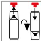
Roten Druckknopf aus der Kappe entnehmen. Dose um 180° drehen und Druckknopf auf den Stift im Dosenboden aufsetzen.
