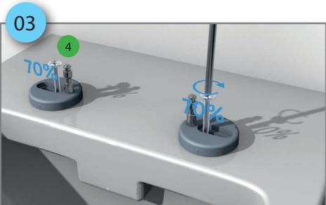
Verschrauben Sie die Edelstahlschrauben (4) mit der Befestigungsplatte (3), so dass die Befestigungsplatte noch leicht beweglich ist (ca. 70%).
