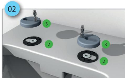
Drücken Sie die Gummiunterlegscheibe (2) von unten auf der Befestigungsplatte (3).
