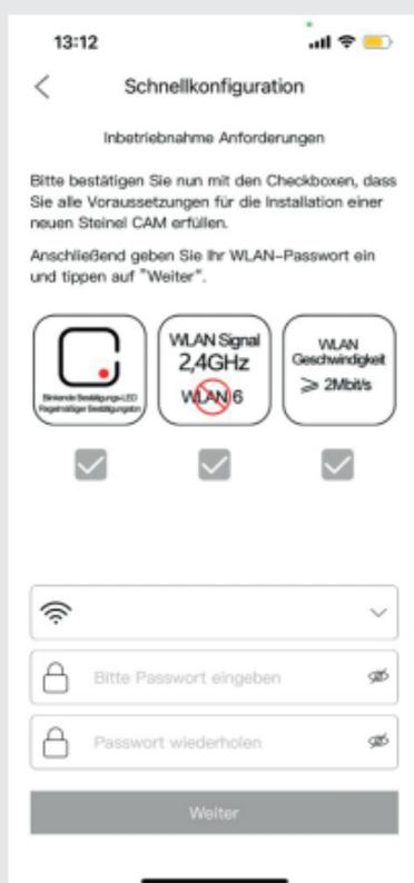
Im Feld „WiFi“ wird der Name des WLAN-Netzwerk-Routers angezeigt.
