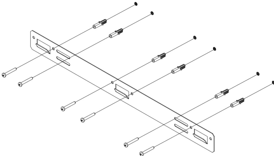
Setzen Sie die Kunststoffdübel in die Bohrlöcher und verwenden Sie die 6x ST5\*40 Schrauben, um die Wandhalterung zu befestigen.
