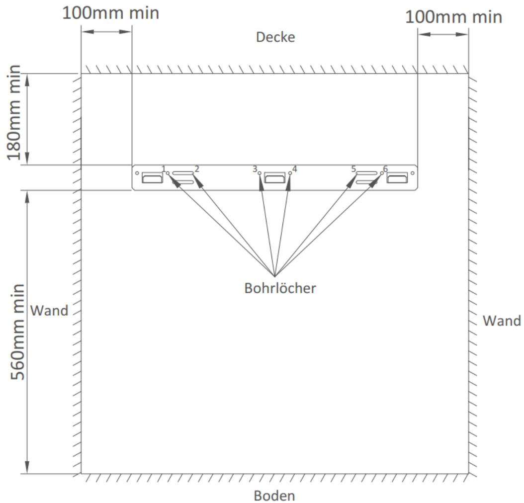
Wählen Sie eine angemessene Wand und markieren Sie die vorgeschlagenen sechs Löcher. Bohren Sie im Anschluss die markierten Löcher mithilfe eines 8mm Bohrer.
