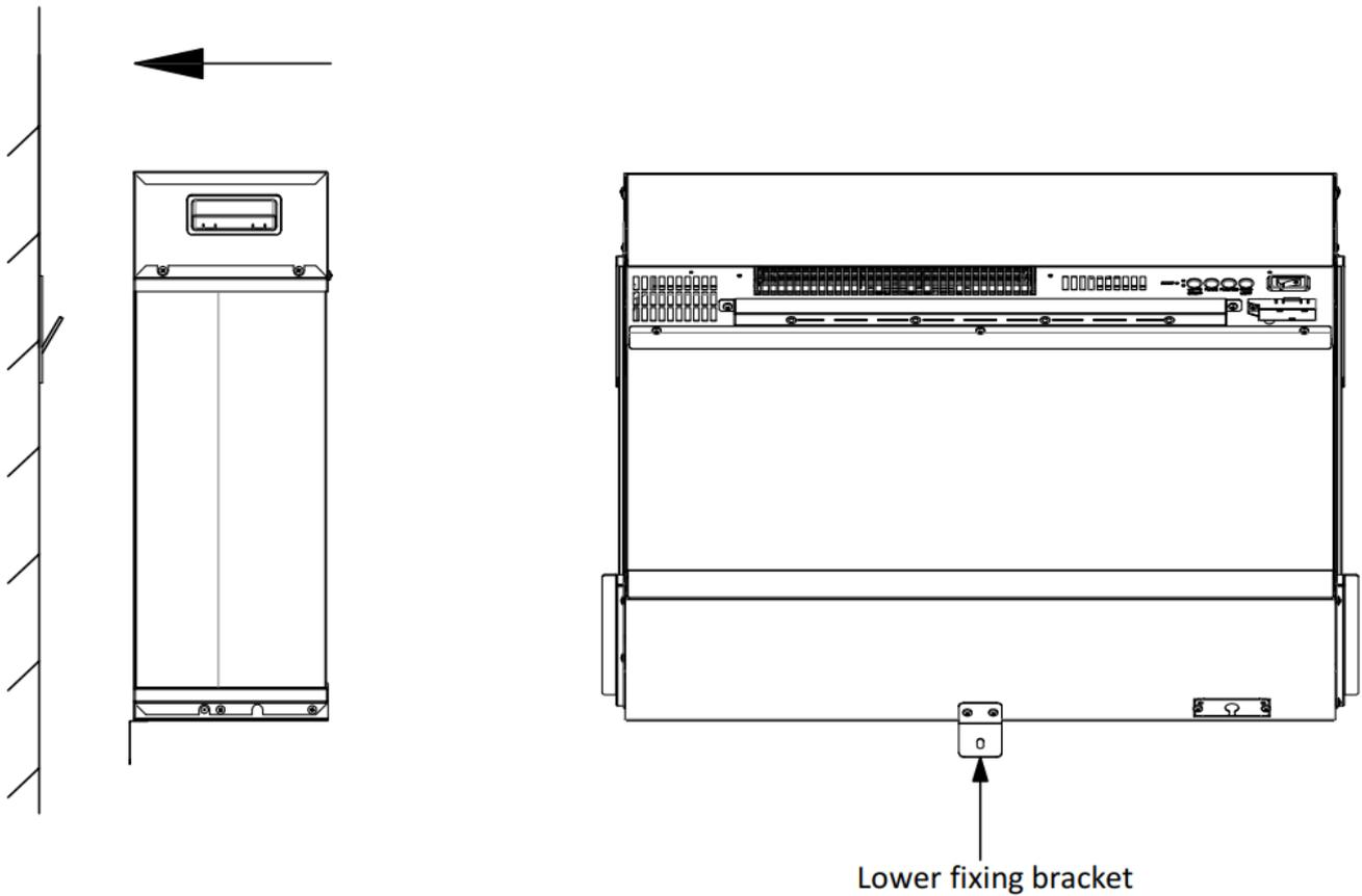
Hängen Sie den Elektrokamin an die Wandhalterung und markieren Sie das Loch der unteren Befestigung. Entnehmen Sie im Anschluss erneut den Elektrokamin.
