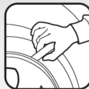
**D** MONTAGE: Kunststoff- oder Metallschutzkappen (Nabenschutzkappen) vor der Montage der Radzierblende entfernen. Spannring richtig einsetzen und Ventilaussparung beachten.
