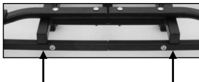
2 x Šroub s křížovou hlavou M5 x 35 2 x Rozpěrný kroužek 8,1 x 5,5 x 1,2 2 x Podložka 9,7 x 5,3 x 0,9
