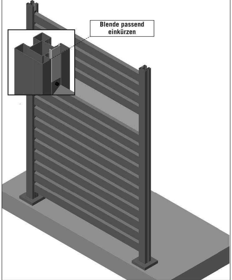
**11** Abdeckblenden in die ungenutzten Ausbuchtungen der Pfosten einschieben
