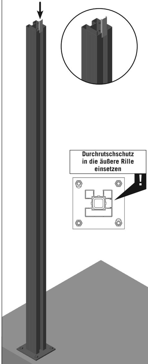
**4** Untere Schraubstege einschieben, justieren und festschrauben
