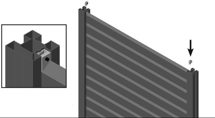
**9** Optional: Durch Lücke der oberen Schraubstege je eine Edelstahl-Schraube als Sicherung in obere Paneele schrauben
