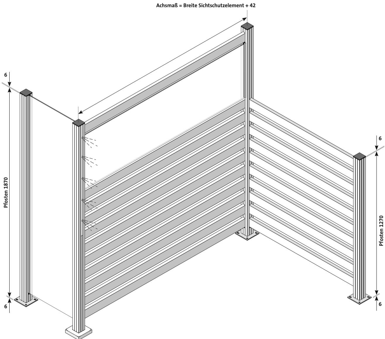
**1** Pfostenanker fachgerecht betonieren bzw. anschrauben
