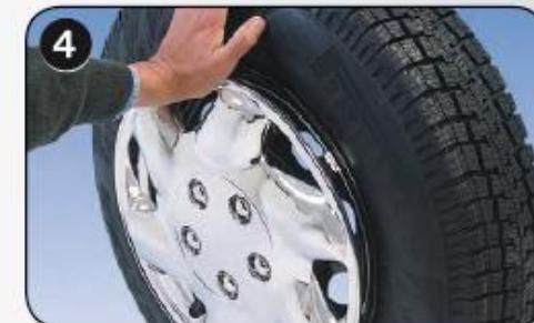
Blende unter leichtem Druck auf deren Rand, ringsherum auf die Felge drücken. Sitzt die Blende zu locker, die Schritte 1-3 wiederholen, den Spannring allerdings in Öffnung C und B einstecken. Sollte der Sitz danach noch nicht ausreichend sein, bitte die Öffnungen B und D verwenden.
