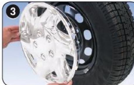
Radzierblende so auf die Felge aufsetzen, dass der Ventilschaft durch die Aussparung am Spannring geführt wird.
