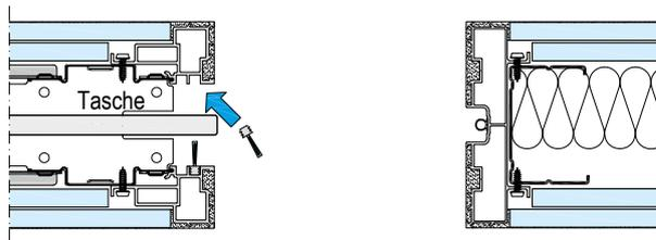
15. Längen Sie die Bürstendichtung auf Schienenlänge ab und drücken Sie dann die Bürstendichtung in die vorgesehene Nut ein.
