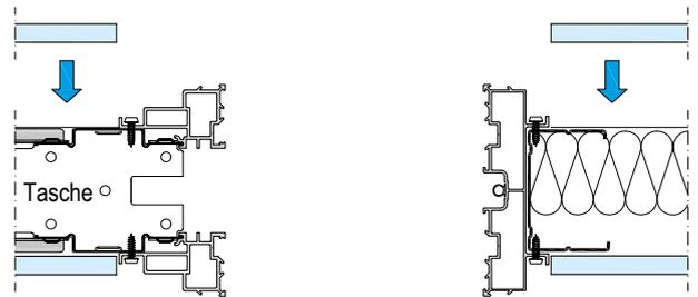
9. Bringen Sie die 1. Beplankungslage an, nach Angaben des geplanten Wandsystems. Im Taschenbereich der Pocke Kit Easy verwenden Sie die Schrauben von der Pocket Kit Easy und überprüfen Sie den Schraubeneinstand, damit es keine Schäden am Türblatt gibt.
