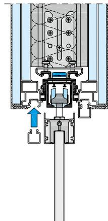
14. Nachdem der Bereich oberflächenfertig ist, kann die Tür montiert werden und die Blendenprofile eingesetzt werden.
