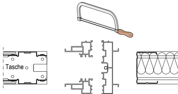
4. Längen Sie die Laibungsprofile und das Anschlagprofil auf das lichte Höheneinbaumass ab.
