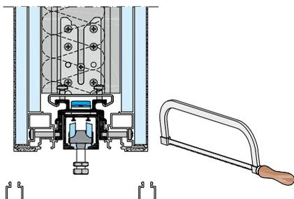
13. Längen Sie die Blendenprofile auf das lichte Einbaumass ab.
