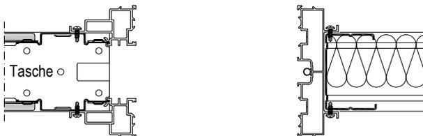
7. Einbauzustand, Laibungsprofile und Anschlagprofil.
