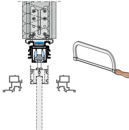
1. Längen Sie die Sturzprofile auf das lichte Einbaumass ab.
