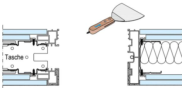
12. Verspachteln Sie die Laibungsprofile sowie das Anschlagprofil.
