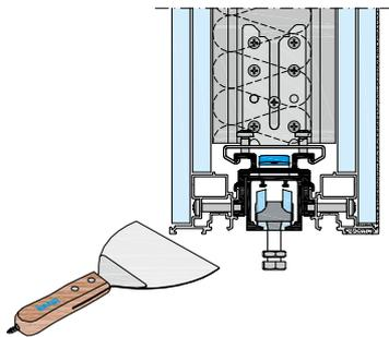
11. Verspachteln Sie die Spachtellaibung und achten Sie darauf, dass die Nut zum Einklicken des Blendenprofils frei von Spachtelmasse bleibt.
