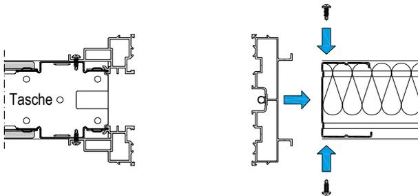
6. Schieben Sie das Anschlagprofil auf das CW-Profil und fixieren Sie dieses mit 5 Blechschrauben LB 3,5x9,5 je Seite.
