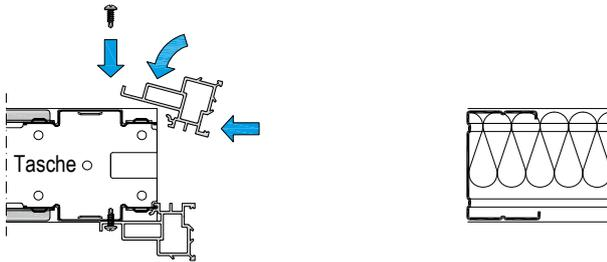
5. Hängen Sie die Laibungsprofile mit der Nut an die Taschenprofile und fixieren Sie diese mit je 5 Blechschrauben LB 3,5x9,5.
