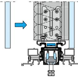
Bild 13: 1. Beplankungslage – Taschen- / Anschlagbereich
