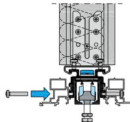
3. Verschrauben Sie die Sturzprofile mit je 4 Flachkopfschrauben M5x25 an die Tragschiene.
