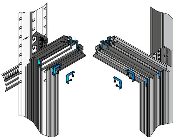
8. Montieren Sie die Aussteifungswinkel (4) in den Ecken der Profile, mit je 2 Blechschrauben LB 3,5x9,5.
