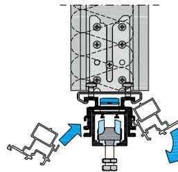
2. Hängen sie die Sturzprofile mit den Laschen in die Führung ein.
