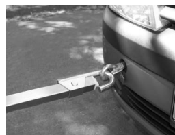
Figuur 1: Aansluiten van de voertuigen
