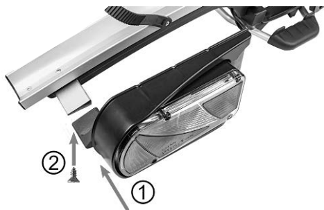
Figura 1: Montaggio luci posteriori
