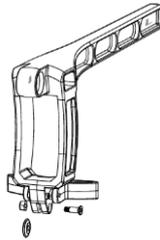
Abgenutztes Schneidrad herausnehmen und neues Schneidrad einsetzen
