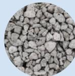
Die gebundene Schüttung zeichnet sich durch erhöhte Druckfestigkeit sowie guten Schallschutz aus und ist ebenfalls durch ihr geringes Gewicht bei Holzbalken- oder auch Trapezblechdecken einsetzbar.
