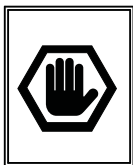
Позиция аварийной остановки
