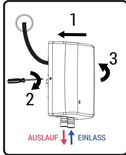
1. Schalten Sie die Stromversorgung aus und bereiten Sie das Netzkabel wie in B1 dargestellt vor.
