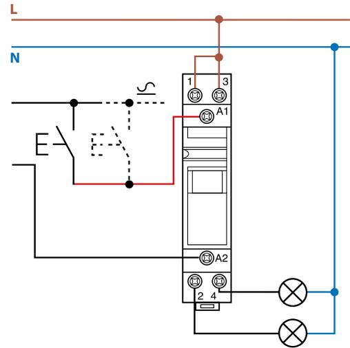
Beispiel für unterschiedliche Spannung an Spule und Kontakten,
