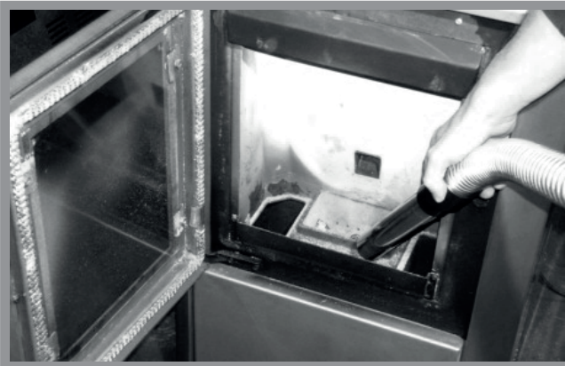
Abb. 12a: Reinigung des Brenntopfes
