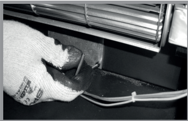
Abb. 13b: Aufschauben der inneren Abdeckplatte
