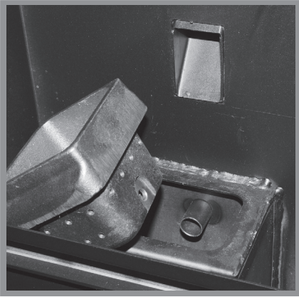
Abb. 6a: Brenntopf einsetzen
