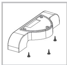
Vor dem Gebrauch des Heizkörpers müssen die Füße (im Karton separat mitgeliefert) an das Gerät gebaut werden. Diese Füße sollen an den
