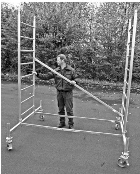
Ta det andre skråstaget, og monter det diagonalt fra første til femte tverrstykke og fest det med sikringssettene som vist på bildet.
