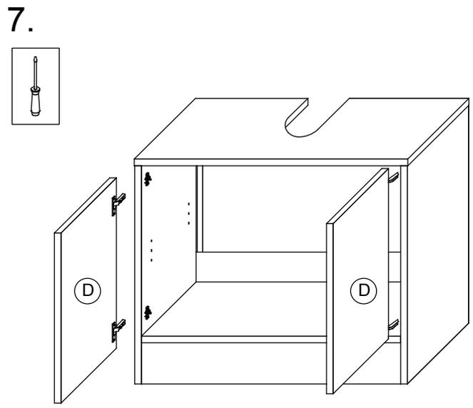
T11 Bei Türmontage das Scharnier einhängen, bis Anschlag öffnen und anschließend festschrauben.
