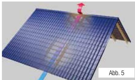
Achten Sie darauf, dass die Luft an der gesamten Dachfläche im Traufbereich ungehindert eintreten und am First ungehindert austreten kann. Eine Luftzirkulation erfolgt nur, wenn Be- u. Entlüftung funktionsfähig sind. Bei Dächern über 8 m Sparrenlänge oder sehr flachen Dächern ist die Belüftung gesondert zu prüfen.
