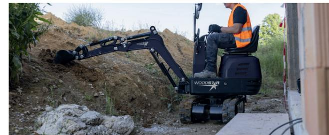
**DANK EINER HOHEN GRABREICHWEITE** von maximal 2330 mm können auch Arbeiten an Böschungen oder Schrägen optimal ausgeführt werden.
