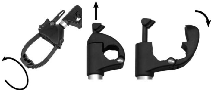
Figura 2: Montaggio braccio di fissaggio
