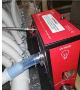
1. Schritt: Lösen Sie die 2 rot markierten Schrauben.
