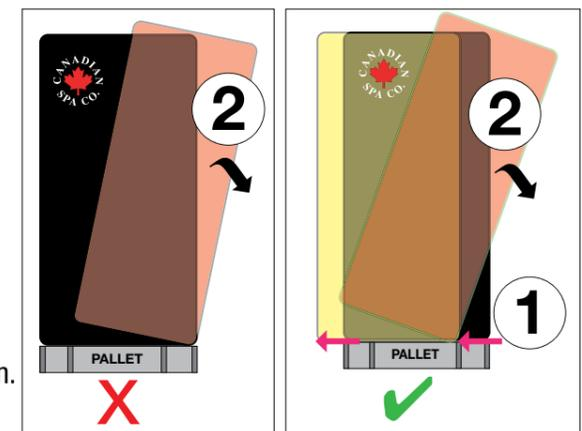
**Um Beschädigungen zu vermeiden, den Whirlpool korrekt abladen**
