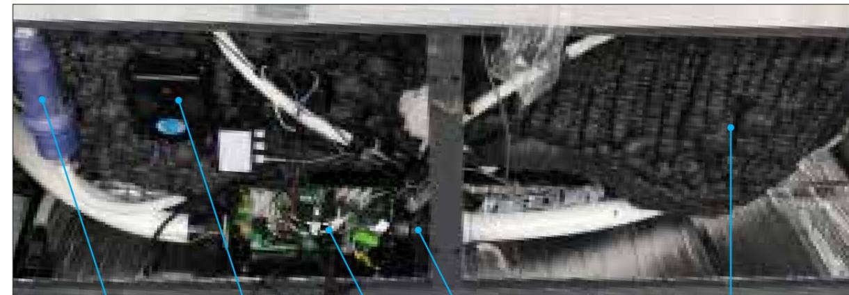
Ozon-Mischkammer Ozongenerator Steuerung Heizung Verdunkelung Isolierung
