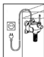
При использовании распределительной штепсельной розетки или отдельного блока питания необходимо располагать их выше подсоединения насоса к сети.
