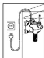
bel entlang laufendes Wasser in die Steckdose gelangt. Bei Verwendung einer Verteiler-Steckdose oder eines externen Netzteils, muss die Platzierung oberhalb des Pumpen-Netzanschlusses erfolgen.
