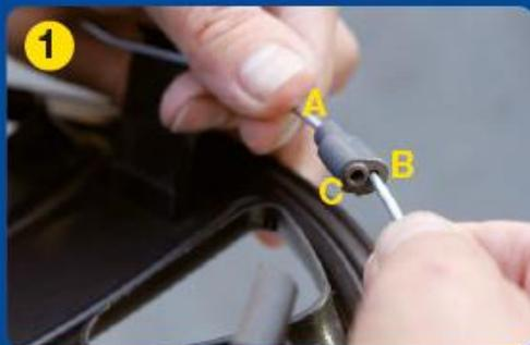
① Ende des Spannring in Öffnung A und B einstecken.
