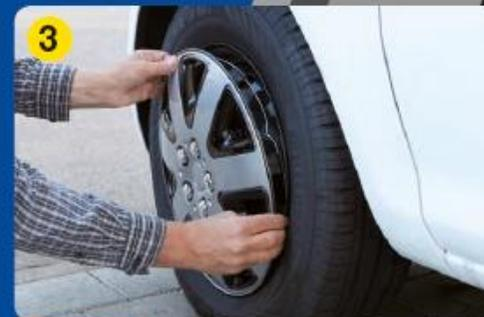
③ Radzierblende so auf die Felge aufsetzen, dass der Ventilschaft durch die Aussparung am Spannring geführt wird.
