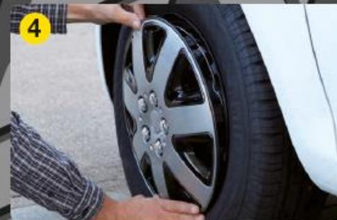
④ Blende unter leichtem Druck auf deren Rand, ringsherum auf die Felge drücken. Sitzt die Blende zu locker, die Schritte 1-3 wiederholen, den Spannring allerdings in Öffnung C einstecken.
