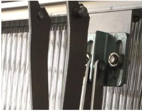
Die Montageplatte des Fensterhebers wird mit Sechskantschraube M6 x 12 (Pos. 6, 2 Stück) am Befestigungswinkel (Pos. 9) verschraubt.
