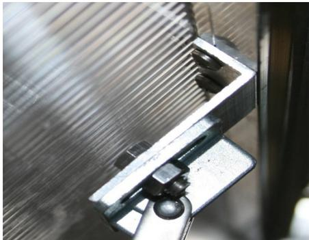
Auch für die Montageplatte (Pos. 10) am oberen Rahmen des Frühbeets müssen zwei Löcher mit einem 3,5 mm-Bohrer gebohrt werden (zwei Wandungen durchbohren). Nehmen Sie die Montageplatte als Hilfe zum Anzeichnen. Zum Verschrauben verwenden Sie die Linsenkopfschrauben 4,2 x 13 (Pos. 8).
