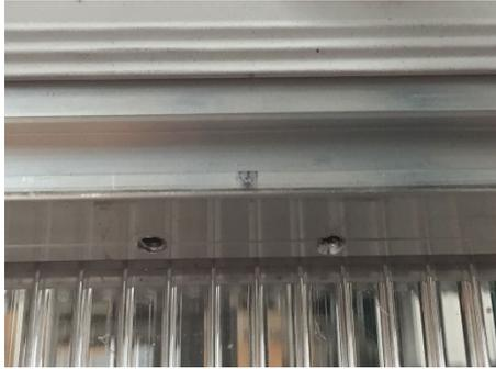
Bohren Sie mit einem 3,5 mm-Bohrer 2 Löcher im Abstand von 28 mm in die Bohrkerfrille auf der Innenseite des Profils am Deckelrahmen (zwei Wandungen durchbohren).
