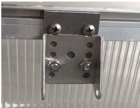
Zusätzlich fixieren Sie die Grundplatte des Fensterhebers (Pos. 5) mit der Montageplatte (Pos. 10) mit den Sechskantschrauben M6 x 12 (Pos. 6, 2 Stück) und Sechskantmuttern M6 (Pos. 7).
