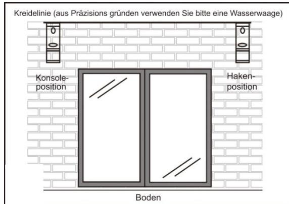
Die Position der Konsole wurde im Werk bereits auf der Markise markiert. Messen Sie die Breite der Markise mit einem Lineal und notieren Sie die Position der Konsolen.
