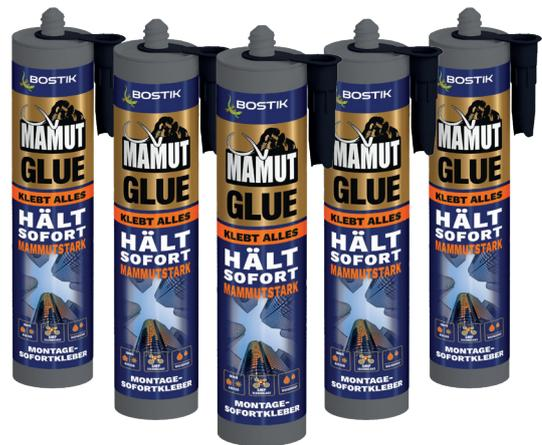
Streifen auftragen. Kartusche im 90° Winkel anwenden. Materialien in Position bringen und fest andrücken, so dass der Kleber mindestens 2 - 3 mm dick zwischen Material und Oberfläche ist. Den Kleber nicht punktförmig auftragen! Aufgrund der besonders hohen Anfangshaftung müssen die verklebten Elemente während des Aushärtungsvorgangs in der Regel nicht abgestützt oder fixiert werden. Für die Spiegelverklebung nur senkrechte Klebestränge verwenden um stauendes Kondenswasser zu vermeiden.
