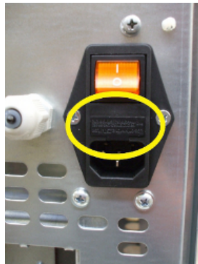
Fig. 82 - Abdeckklappe mit Sicherungen, die ausgewechselt werden müssen
