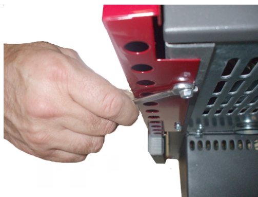
Fig. 30 - Befestigung der Platten
