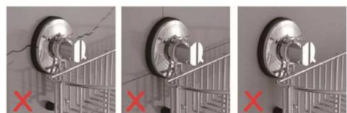
Wij bevelen aan om de zuignappen elke 1 à 2 maanden op dichtheid te controleren. Draai hiervoor de bovenste knop linksom naar de uitgangspositie en herhaal stap 5 en 6 van de montagehandleiding. U hoeft het mandje daarbij niet geheel van de wand te nemen.
