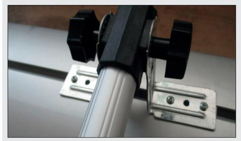
Abb.1d: Heizkopf mit Rohr verbinden
