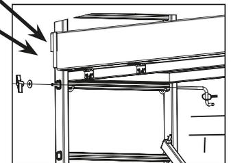
**(DE) Befestigung des Gerüsts an einer Wand**
