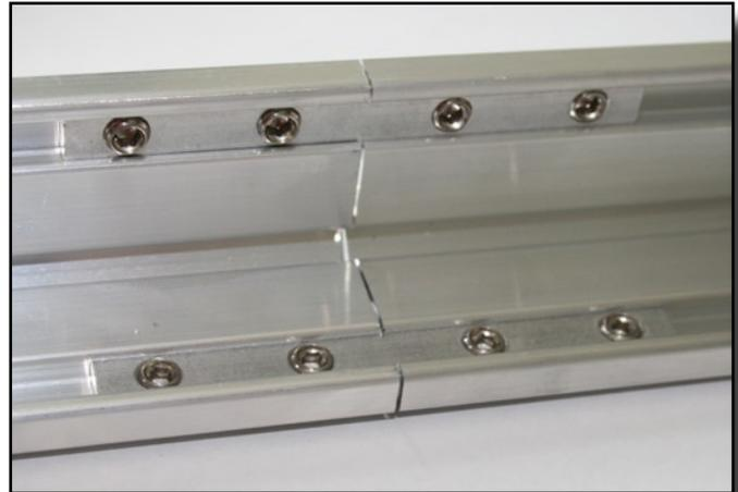
Die Profile (Pos. 1 bzw. Pos. 1.1) sind, wie dargestellt, so zu verbinden, dass folgende Profillängen entstehen:
