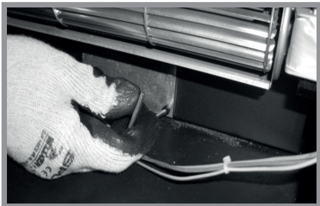
Abb. 13b: Aufschrauben der inneren Abdeckplatte
