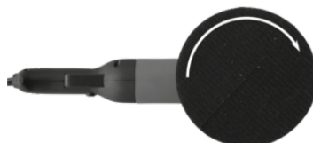
Figure 3 : Vissage du plateau de polissage
