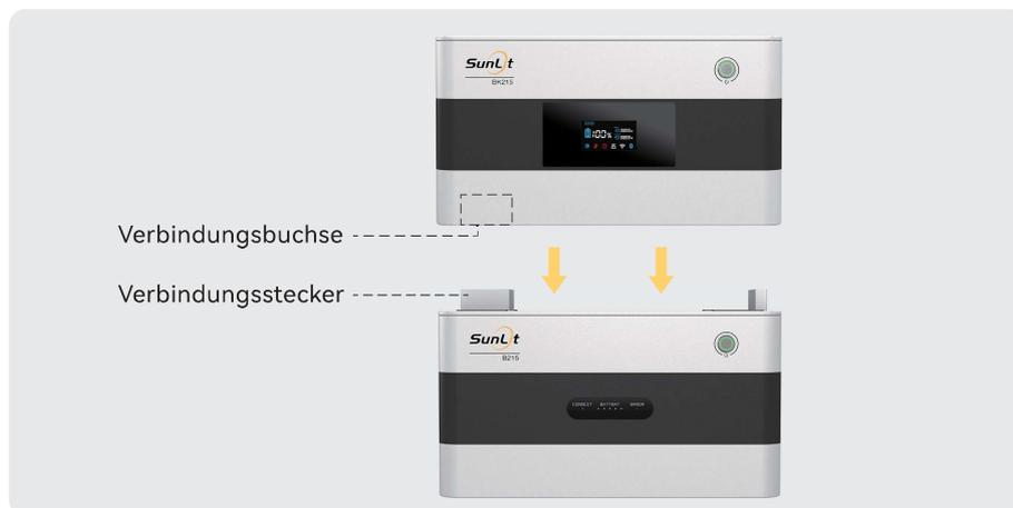
Der Balkonkraftwerkspeicher BK215 wird mit dem Erweiterungsspeicher B215 parallel geschaltet. Es können bis zu 3 Erweiterungsspeicher gleichzeitig angeschlossen werden, wobei die Verbindungsbuchse und der Verbindungsstecker mit Kommunikationssignalen ausgestattet sind. Durch diese Kommunikation wird der Speicher in Kombination aus Balkonkraftwerkspeicher und Erweiterungsspeichern gleichmäßig ge- und entladen, wodurch eine lange Lebensdauer des Produktes ermöglicht wird.
