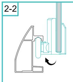
Bitte hängen Sie die oberen Laufrollen in die obere Laufschiene ein. Anschließend drücken Sie bitte die unteren Laufrollen nach unten und schieben diese in die untere Laufschiene.
