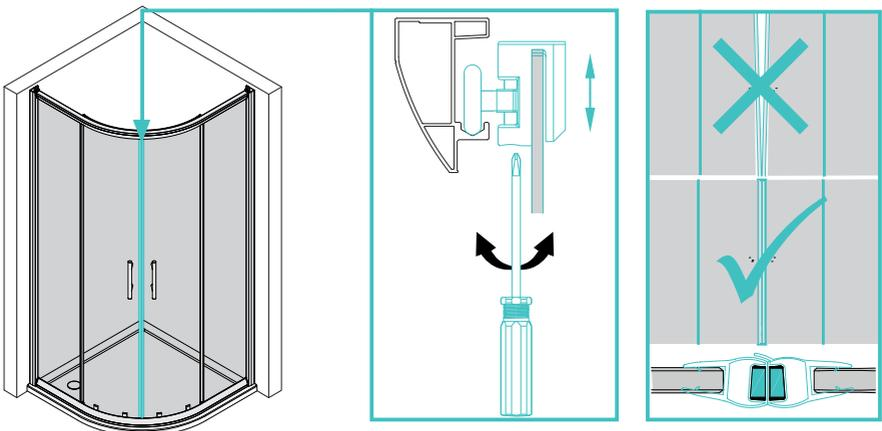
Wenn die Schiebetüren nicht richtig schließen oder ein Spalt zwischen den Magneteleisten oben oder unten entsteht, dann müssen Sie zum Ausrichten der Kabine die Schrauben an den oberen Laufrollen im oder gegen den Uhrzeigersinn drehen.
