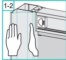
Bitte befestigen Sie das Klipsprofil mit beiden Händen vorsichtig von innen auf dem Wandprofil, indem Sie das Profil mit der einen Hand fixieren und es vorsichtig mit der anderen Handkante in das Profil einschlagen. Achten Sie darauf, dass die einzelnen Schläge dicht aufeinander erfolgen.
