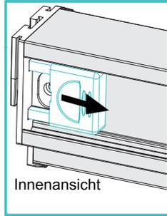
Bitte achten Sie auf die angegebene, geöffnete Position der Rahmenverbindung aus Kunststoff.
