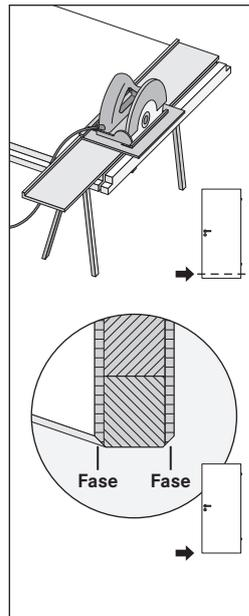
Wenn das Türblatt deutlich zu lang ist und auf voller Breite über den Boden schleift, können Sie das Türblatt unten vorsichtig kürzen.
