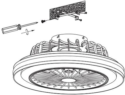
Leuchte / Ventilator mit der Halterung verschrauben.
