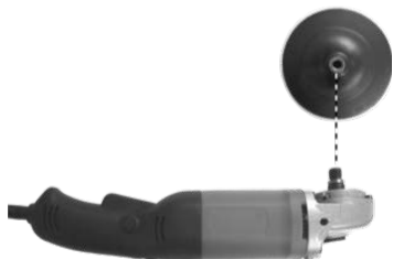
Afb. 2: De polijstschiif monteren
