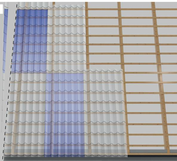
Der überstehende Teil der Platten wird danach abgeschnitten.
