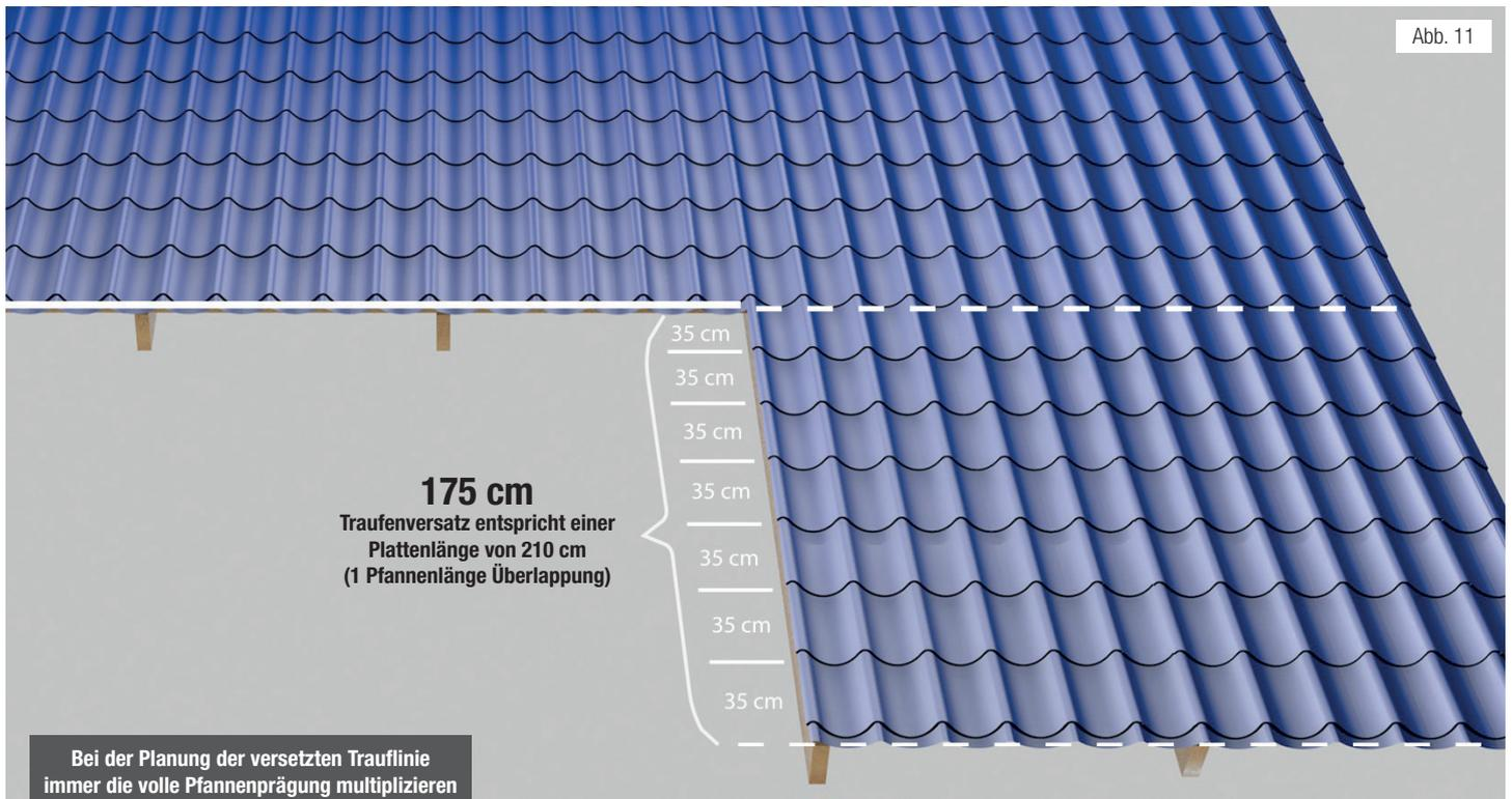
Dieses Maß zur Hauptplattenlänge addiert, ergibt die Gesamtplattenlänge, vorausgesetzt die Montage erfolgt in einer Plattenlänge. Andernfalls Überlappungsvorschrift (Abb. 9) genau beachten!
