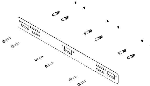
5.3d Hängen Sie den Elektrokamin an die Wandhalterung und markieren Sie die beiden Löcher an den L-Halterungen, die am unteren Teil des Kamins befestigt sind. Nehmen Sie im Anschluss den Kamin herunter.
