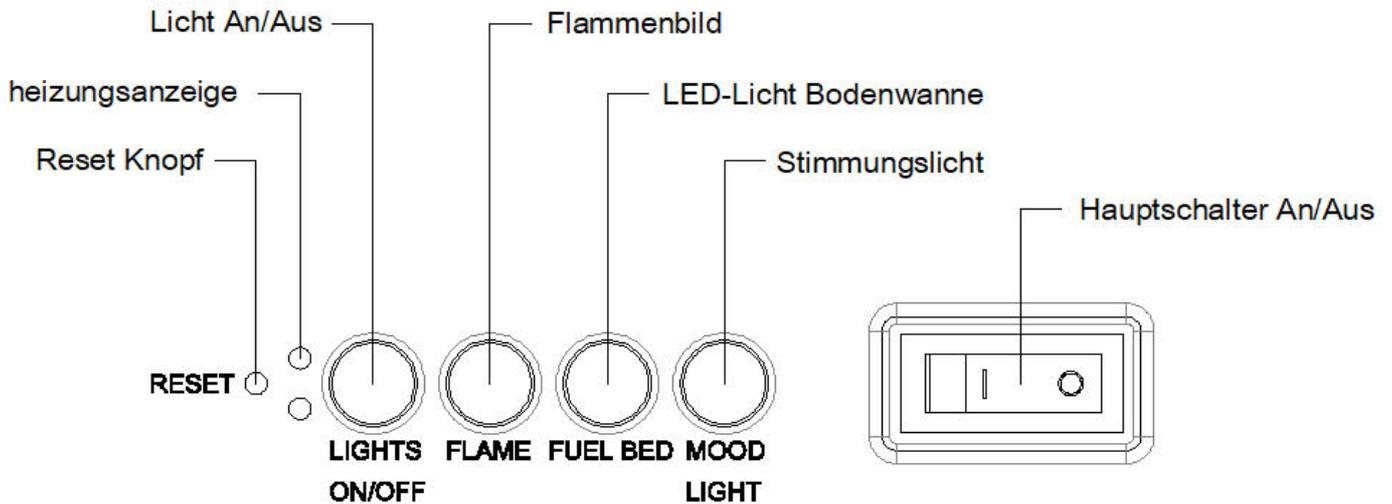
**HINWEIS:** Die manuellen Tasten steuern grundlegende Funktionen, jedoch nicht alle Bedienelemente. Verwenden Sie die Fernbedienung, um alle Funktionen auszuführen.
