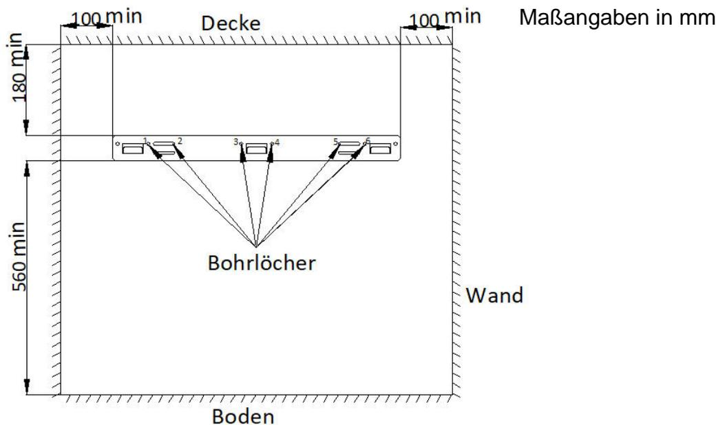
5.3c Setzen Sie die Dübel in die gebohrten Löcher ein und nutzen Sie die sechs ST5\*40 Schrauben um die Halterung an der Wand zu befestigen.
