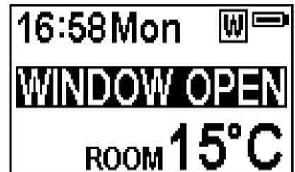
6b.36 Nachdem die Innentemperatur angestiegen ist oder eine manuelle Übersteuerung der Warnung (durch Bestätigen der Fernbedienung) erfolgt ist, kehrt das Gerät in den normalen Betriebszustand zurück.
