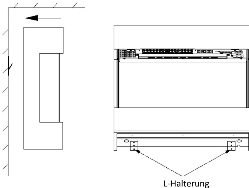
5.3e Bohren Sie die zwei Löcher mit einem 8mm Bohrer und setzen Sie die Dübel ein. Hängen Sie den Elektrokamin wieder ein und nutzen Sie die zwei Schrauben ST5\*40, um die L-Halterung an der Wand zu befestigen.
