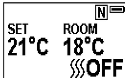
6b.14 Drücken Sie die Taste '+' und '-' um die Einstellungstemperatur von 17°C bis 25°C in zwei Intervallen einzustellen.
