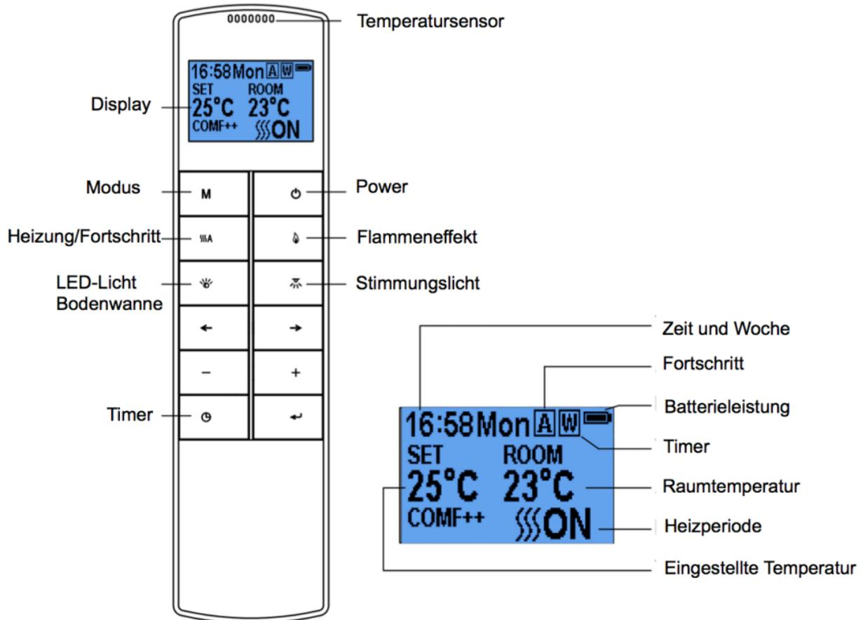
**HINWEIS:** Dies ist eine thermostatische Fernbedienung. Die Fernbedienung sollte sich im selben Raum wie der Kamin befinden und auf einer ebenen Fläche stehen. Die Fernbedienung muss vom Kamin weg platziert werden, damit die heiße Luft nicht den thermostatischen Messwert beeinflusst.
