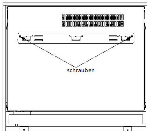
5.3b Wählen Sie eine stabile Wand aus und markieren Sie die sechs Löcher der Wandhalterung. Bohren Sie mithilfe des passenden Bohrers, die gekennzeichneten Löcher.
